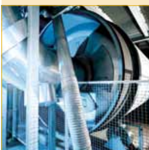
Trommelrockner zur umweltfreundlichen Produktion von hochwertigem Granulat aus Klärschlamm (Quelle: Andritz)
